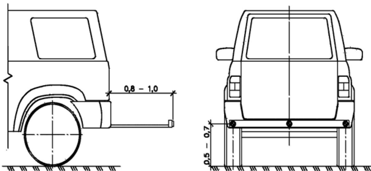
Рисунок Д.1 - Схема установки фильтров на автомобиль-лабораторию
