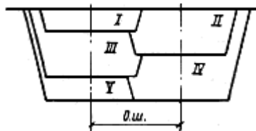
Рис. 24. Последовательность вытрамбовывания котлована в два следа под спаренный фундамент у осадочного шва (о.ш.)
