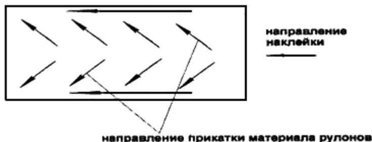
Рис.7.3. Схема прикатки гидроизоляционного материала
