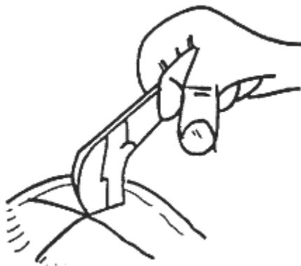
Рис.10.1. Устранение дефекта - разрезка пузыря
